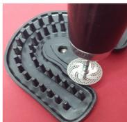
Per modelli con impianti sezionabili, nei casi in cui l'analogo sia messo di traverso, perché il modello non venga troppo alto, abbassare i perni della piastra solo dove necessita con una fresa disco, oppure con la squadra modelli abbassarli tutti (**idem x i porta lavoro**)
